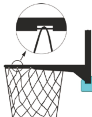
図5 リングネットの取付(例) Diagram 5 Attachment of the net (example)
